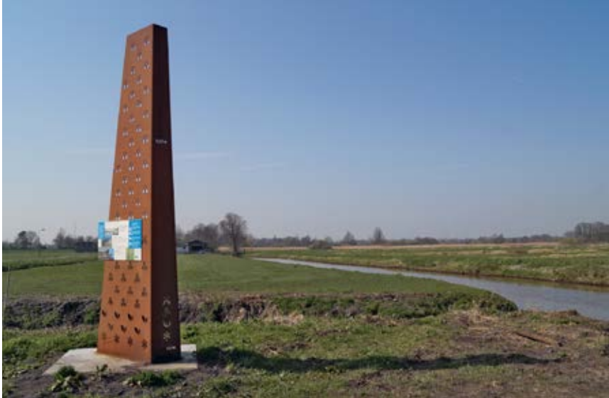
Afb. 3 Op deze 'veenzuil' aan de Middenweg in de Bethunepolder is goed te zien hoeveel en door welke omstandigheden het maaiveld gedaald is. De bovenkant van de zuil geeft de oorspronkelijke hoogte van het maaiveld aan.
